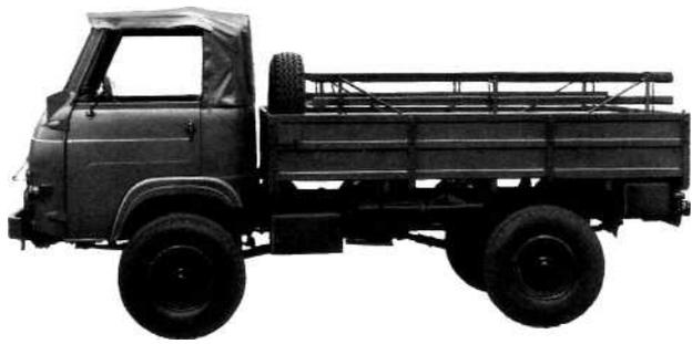
Châssis cabine de 1,600 à 1,790 T de charge totale, facile à carrosser, bonne garde au sol, faculté de gravir des rampes de 45%
