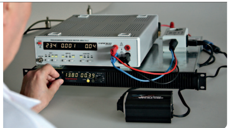
INVERTTEREIDEN ominaisuudet tutkittiin Hameg-vaihtosähköanalysaattorilla, joka näyttää niiden antojännitteen, -virran ja tehon yhtäaikaaisesti.
